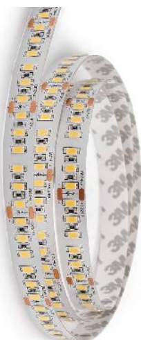
Corp de iluminat Lentă LED 12V 10W m/l., 4500K, 14 m.l.
